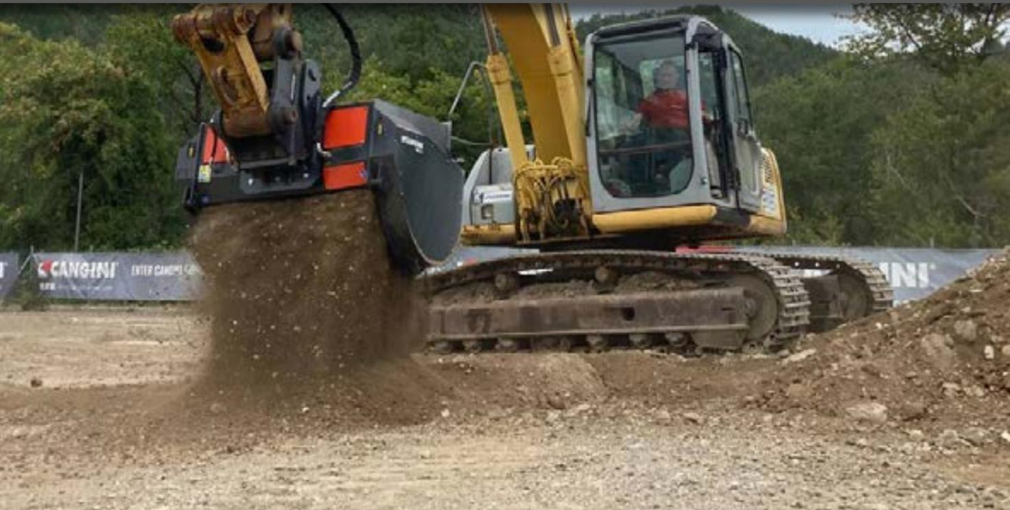
DER SIEBLÖFFEL VRC EIGNET SICH ZUM AUSSIEBEN DIVERSE MATERIALIEN BEI ABRUCH- ODER AUSHUBARBEITEN DIE SIEBBAREN MATERIALSTÄRKEN REICHEN IN DER STANDARDKONFIGURATION VON 0-35MM. DAS DESIGN ERLEICHTERT DIE MATERIALAUFNAHME UND VERHINDERT EINE VORZEITIGE ABNUTZUNG. DAS SIEBSYSTEM KANN FÜR EINE EINFACHE WARTUNG PROBLEMLOS AUSGETAUSCHT WERDEN; DAS SORTIEREN ERFOLGT MIT HILFE EINER WELLENGRUPPE AUS EXTREM ROBUSTEM, DEREN AUFBAU DIE SIEBFLÄCHE VERGRÖßERT UND DIE PRODUKTIVITÄT OPTIMIERT.
