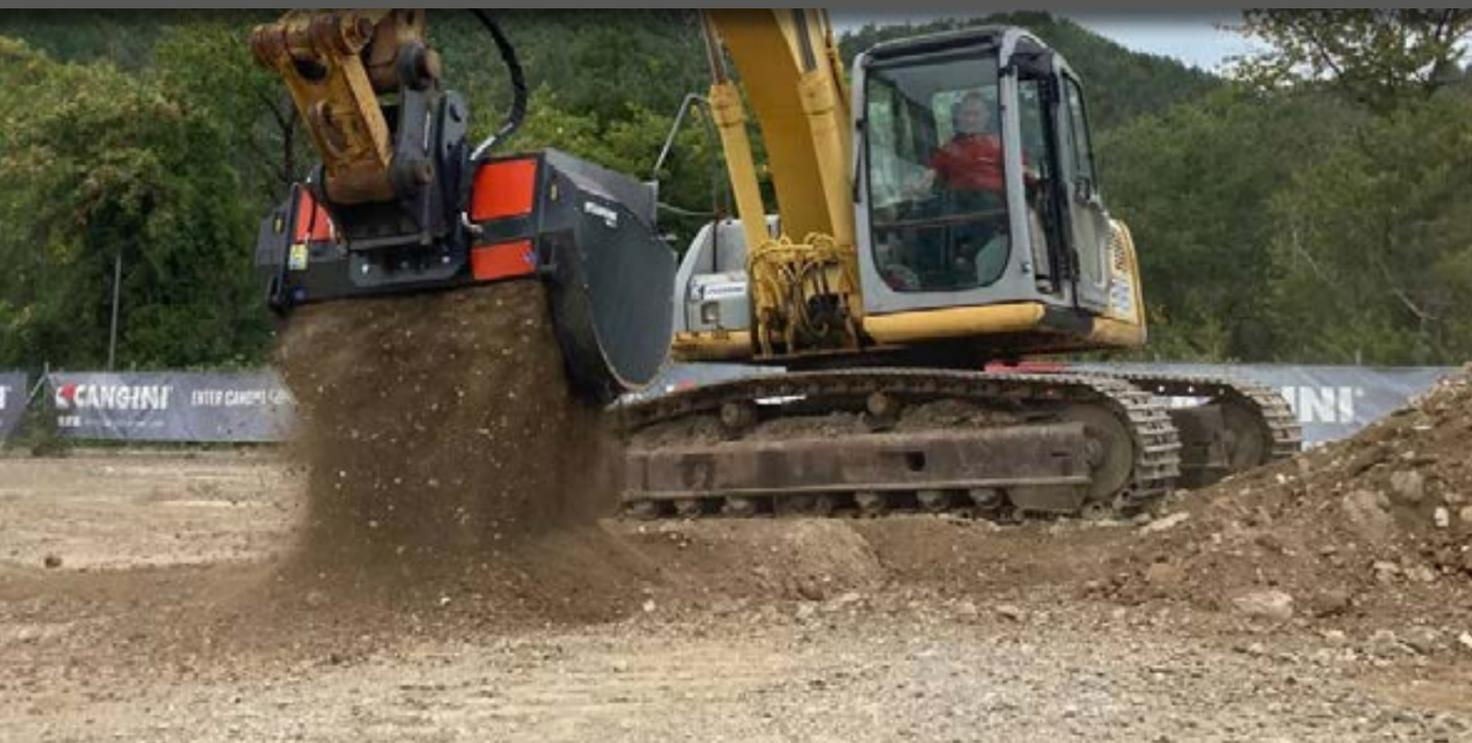
LA BENNA VAGLIATRICE VRC È ADATTA ALLA SELEZIONE DI DIVERSI MATERIALI DERIVATI DA DEMOLIZIONI O SCAVI. LO SPESSORE DEL MATERIALE DA VAGLIARE VA DA 0-35MM IN CONFIGURAZIONE STANDARD. IL SUO DESIGN È PENSATO PER FACILITARE IL CARICO DEL MATERIALE ED EVITARE USURE. IL SISTEMA DI VAGLIO È FACILMENTE SOSTITUIBILE PER UNA SEMPLICE MANUTENZIONE. LA SELEZIONE AVVIENE ATTRAVERSO UN GRUPPO ALBERI DISTRIBUITO PER UNA MAGGIORE PRODUTTIVITÀ.
