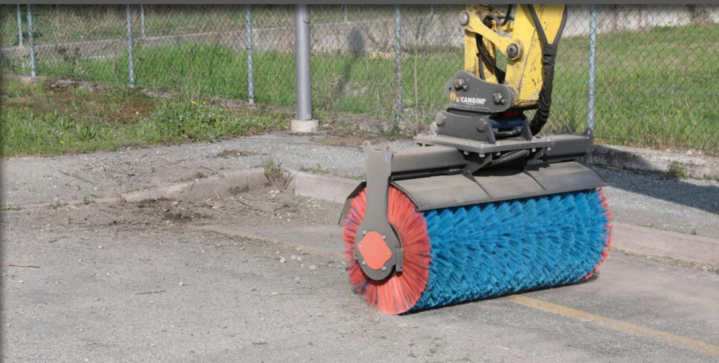
IL RULLO SPAZZOLONE PER ESCAVATORE È INDICATO PER LA PULITURA DI SUPERFICI ORIZZONTALI, VERTICALI E IN AREE NON RAGGIUNGIBILI CON MACCHINE FRONTALI. DOTATO DI PIEDI STABILIZZATORI PER LA SALVAGUARDIA DELLE SPAZZOLE DURANTE IL POSIZIONAMENTO DELL'ATTREZZATURA A TERRA. VALVOLA DI MASSIMA PRESSIONE DI SERIE. IL MOTORE A TRASMISSIONE DIRETTA CON DISTRIBUZIONE A DISCO È ALLOGGIATO ALL'INTERNO DELL'ALBERO PORTA SPAZZOLE AL FINE DI RIDURRE AL MINIMO GLI INGOMBRI OPERATIVI DELLA SPAZZATRICE.
