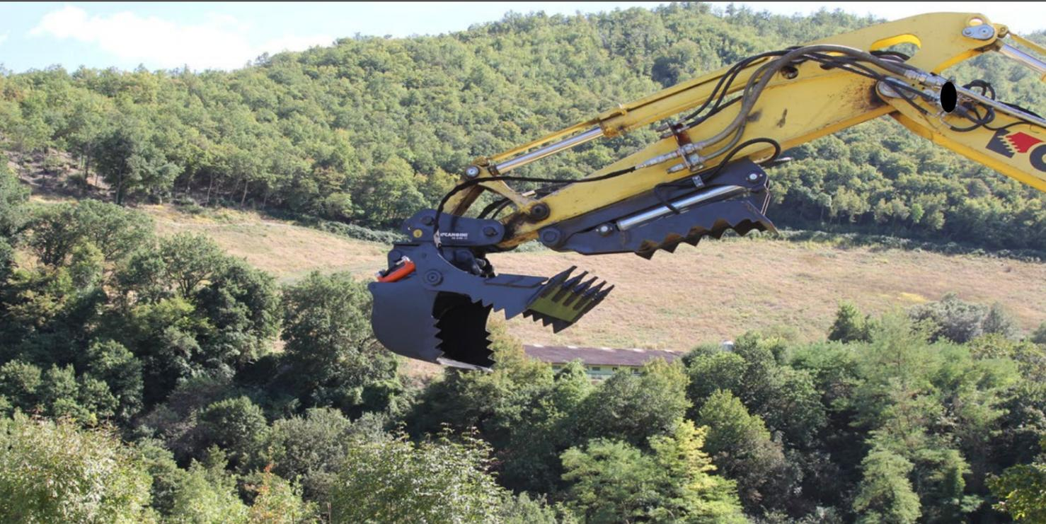
DIE 4-IN-1-SCHAUFEL IST EIN MULTIFUNKTIONALES GERÄT, DAS FÜR VERSCHIEDENE AUFGABEN AUF DER BAUSTELLE EINGESETZT WERDEN KANN. IDEAL FÜR AUSHUB-, ABLADE- UND LADETÄTIGKEITEN. AUCH FÜR NIVELLIERUNGS- UND VERFÜLLUNGSARBEITEN GEEIGNET. DIE DOPPELT GEZAHNTE SCHAUFEL ERMÖGLICHT ZUDEM DAS GREIFEN VERSCHIEDENER MATERIALIEN.
