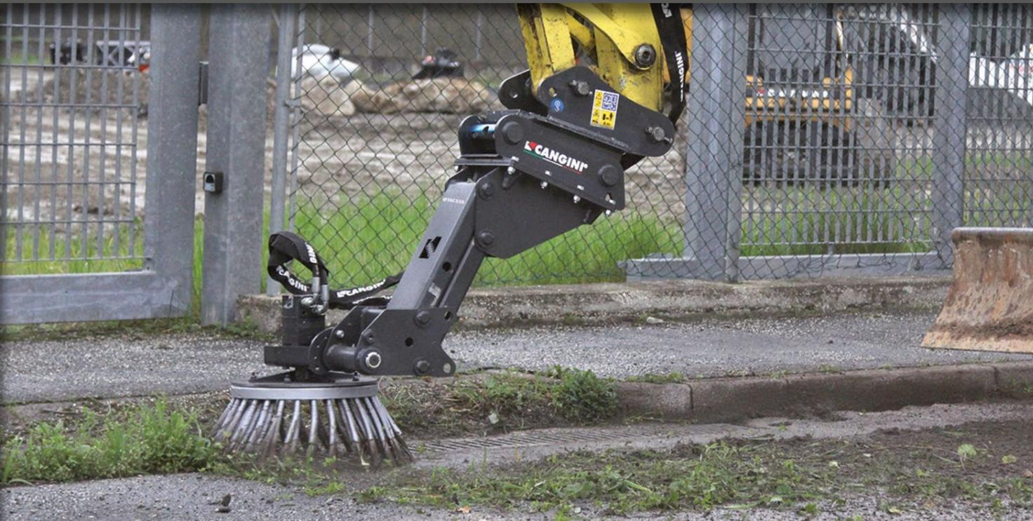
GELENKBÜRSTE MIT STAHLBORSTEN, DAHER IDEAL FÜR TIEFES AUSKEHREN ODER DAS ENTFERNEN VON UNKRAUT AN BORDSTEINEN, GEHWEGEN, BANKETTEN ODER ASPHALT. FÜR EINE OPTIMALE ANPASSUNG AN DEN ZU REINIGENDEN UNTERGRUND IST DIE BÜRSTE ZWEIFACH GELAGERT. BEIDE MECHANISMEN KÖNNEN BEI BEDARF ARRETIERT WERDEN. MIT DER "PP-BÜRSTE" (ZUBEHÖR) WERDEN EMPFINDLICHE FLÄCHEN GEKEHRT, BEI DENEN DIE ENTFERNUNG VON UNKRAUT NICHT NOTWENDIG IST.
