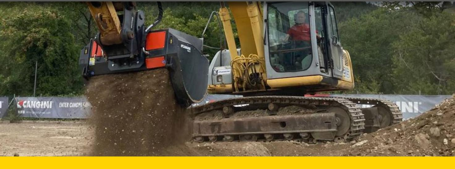
DER SIEBLÖFFEL VRC EIGNET SICH ZUM AUSSIEBEN DIVERSE MATERIALIEN BEI ABRUCH- ODER AUSHUBARBEITEN DIE SIEBBAREN MATERIALSTÄRKEN REICHEN IN DER STANDARDKONFIGURATION VON 0-35MM. DAS DESIGN ERLEICHTERT DIE MATERIALAUFNAHME UND VERHINDERT EINE VORZEITIGE ABNUTZUNG. DAS SIEBSYSTEM KANN FÜR EINE EINFACHE WARTUNG PROBLEMLOS AUSGETAUSCHT WERDEN; DAS SORTIEREN ERFOLGT MIT HILFE EINER WELLENGRUPPE AUS EXTREM ROBUSTEM, DEREN AUFBAU DIE SIEBFLÄCHE VERGRÖßERT UND DIE PRODUKTIVITÄT OPTIMIERT.
