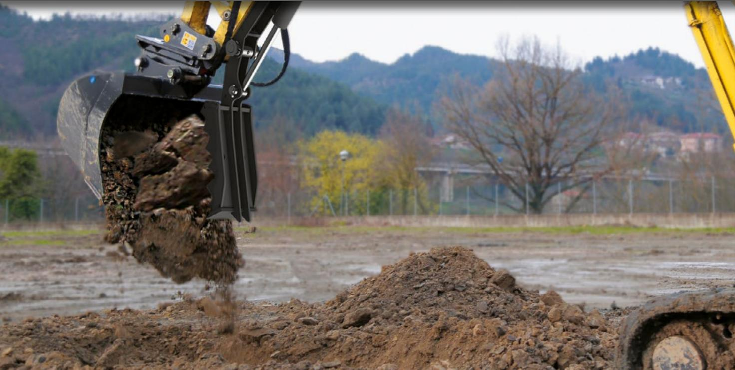
DER AM AUSLEGERANGESCHWEISSTE DAUMEN GRT CANGINI FUNGIERT ALS ZANGE UND ERLEICHTERT DAS ERGREIFEN VON FELSIGEM MATERIAL, BAUMSTÄMMEN UND ANDEREM SPERRIGEN GUT. GANZ EINGEKlapPT KANN DER LÖFFEL NORMAL EINGESETZT WERDEN, WAS DIE ARBEIT DES BEDIENERS WESENTLICH ERLEICHTERT.
