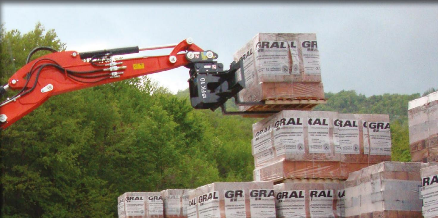
MIT DER PALETTENGABEL AM BAGGER ERREICHEN SIE POSTIONEN, DIE SONST NUR SCHWER ZUGÄNGLICH SIND. ES MUSS SICHERGESTELLT SEIN, DASS DER BAGGER DEN ANFORDERUNGEN DER MASCHINENRICHTLINIE FÜR DAS HEBEN VON LASTEN ENTSPRICHT.
