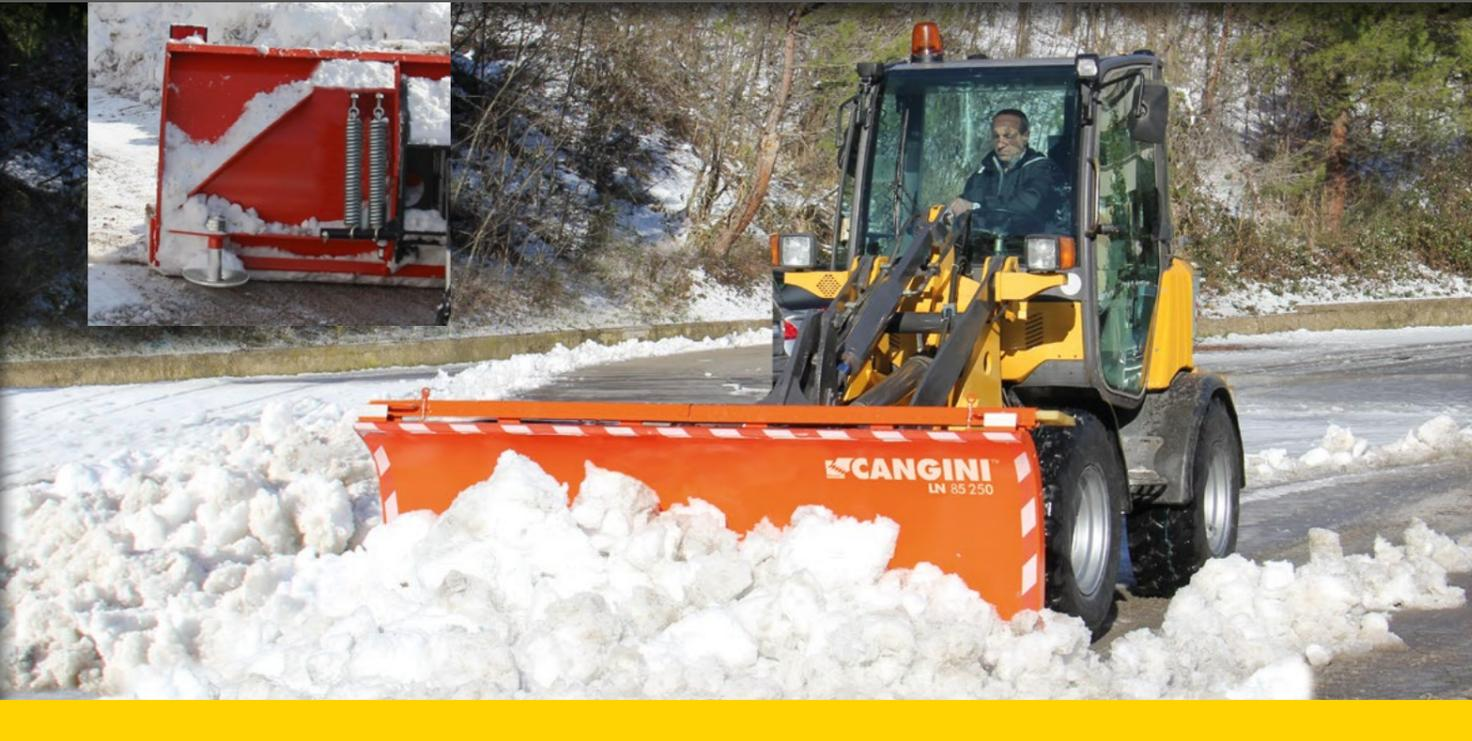
TIENE VÁLVULAS ANTICHOQUE, INCLINACIÓN HIDRÁULICA ±30°, SISTEMA DE AUTONIVELACIÓN ±10° A LA SUPERFICIE VIAL Y PATAS DE APOYO AJUSTABLES. EN CASO DE CHOQUE, SE VOLTEA TODA LA VERTEDERA Y RETORNA A SU POSICIÓN MEDIANTE UN MUELLE.
