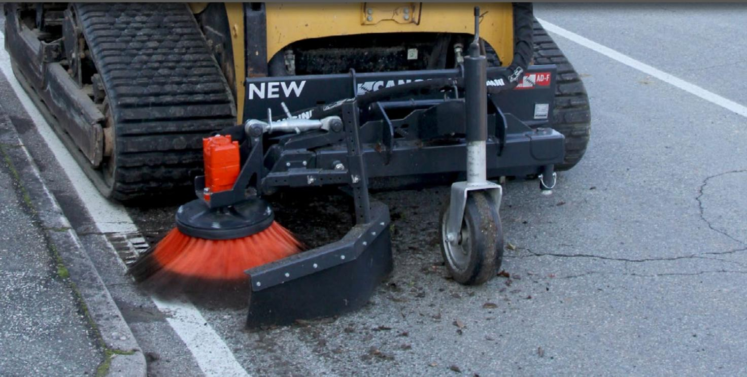
EL CEPILLO FRONTAL PUEDE SER FACILMENTE MONTADO TANTO A LA DERECHA COMO A LA IZQUIERDA, PARA PODER LIMPIAR LOS DOS LADOS DE LA CARRETERA. SISTEMA FLOTANTE Y DE ARTICULACIÓN PERMITEN SEGUIR LA TENDENCIA DEL TERRENO.
