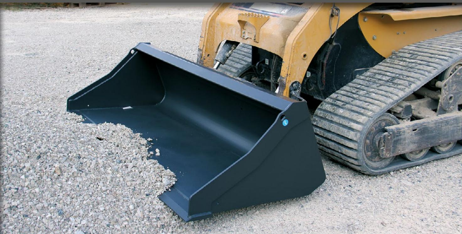
LA CUCHARA FRONTAL PARA MINICARGADORA PROPORCIONA UNA CAPACIDAD DE CARGA ÓPTIMA GRACIAS A SU PERFIL DISEÑADO PARA UNA MEJOR SUPERFICIE DE CONTACTO CON EL SUELO. SU FORMA PERMITE MANTENER EN SU INTERIOR MATERIALES FINOS Y GRANULARES, EVITANDO LA PÉRDIDA DE MATERIAL DURANTE EL TRANSPORTE. ES LA CUCHARA IDEAL PARA CARGAR Y DESCARGAR DIVERSOS MATERIALES. EL ROBUSTO DISEÑO DE LA LEVELMAX GARANTIZA UNA LARGA VIDA ÚTIL DEL EQUIPO.
