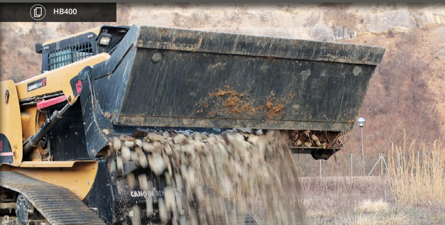
SE UTILIZA PARA LAS OPERACIONES DE CARGA, DESCARGA Y MANIPULACIÓN. GRACIAS A LA APERTURA HIDRÁULICA, TAMBIÉN SE UTILIZA PARA AGARRAR OBJETOS, REGULAR LA DESCARGA DE ÁRIDOS O NIVELAR EL TERRENO.
