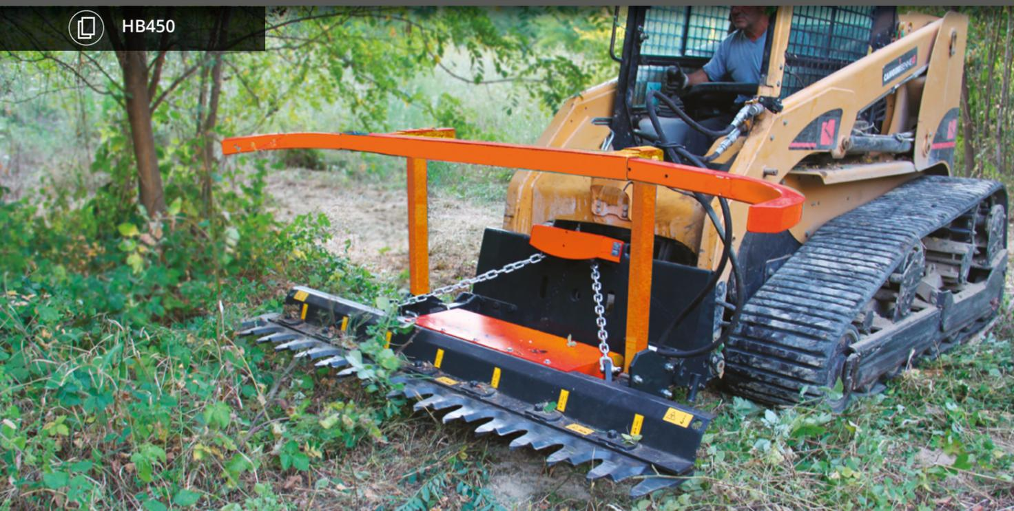
EL CABEZAL CORTADOR DE RAMAS SHARP-CUT SE UTILIZA PARA LA PODA DE RAMAS DE 0 A 100 MM. CON SU CORTE NETO Y PRECISO, NO ARRUIÑA LA PLANTA NI ARRANCA LA RAMA. LAS CUCHILLAS DE LA SIERRAS SON DE HB450, QUE GARANTIZA UNA GRAN DURACIÓN Y RESISTENCIA.
