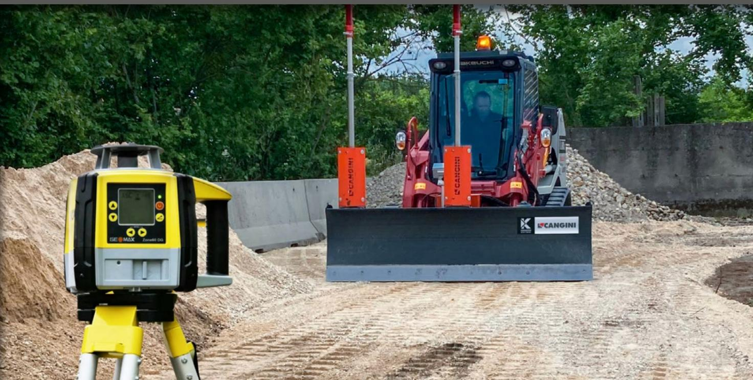
CANGINI RECOMMANDE DE COUPLER L'ÉMETTEUR GEOMAX DG60 OU 75 AVEC LA LAME DE BULL LASER XPLANE POUR UN TRAVAIL EFFICACE. CET ÉMETTEUR EST 100% COMPATIBLE AVEC LE SYSTÈME ÉLECTRONIQUE DE LA LAME DE BULL LASER XPLANE DE CANGINI. LES TRANSMETTEURS DG 60 ET 75 SONT ÉQUIPÉS D'UN AUTONIVELAGE HORIZONTAL ET VERTICAL AVEC PENTE NUMÉRIQUE AUTOMATIQUE SUR DEUX AXES (DUAL GRADE).
