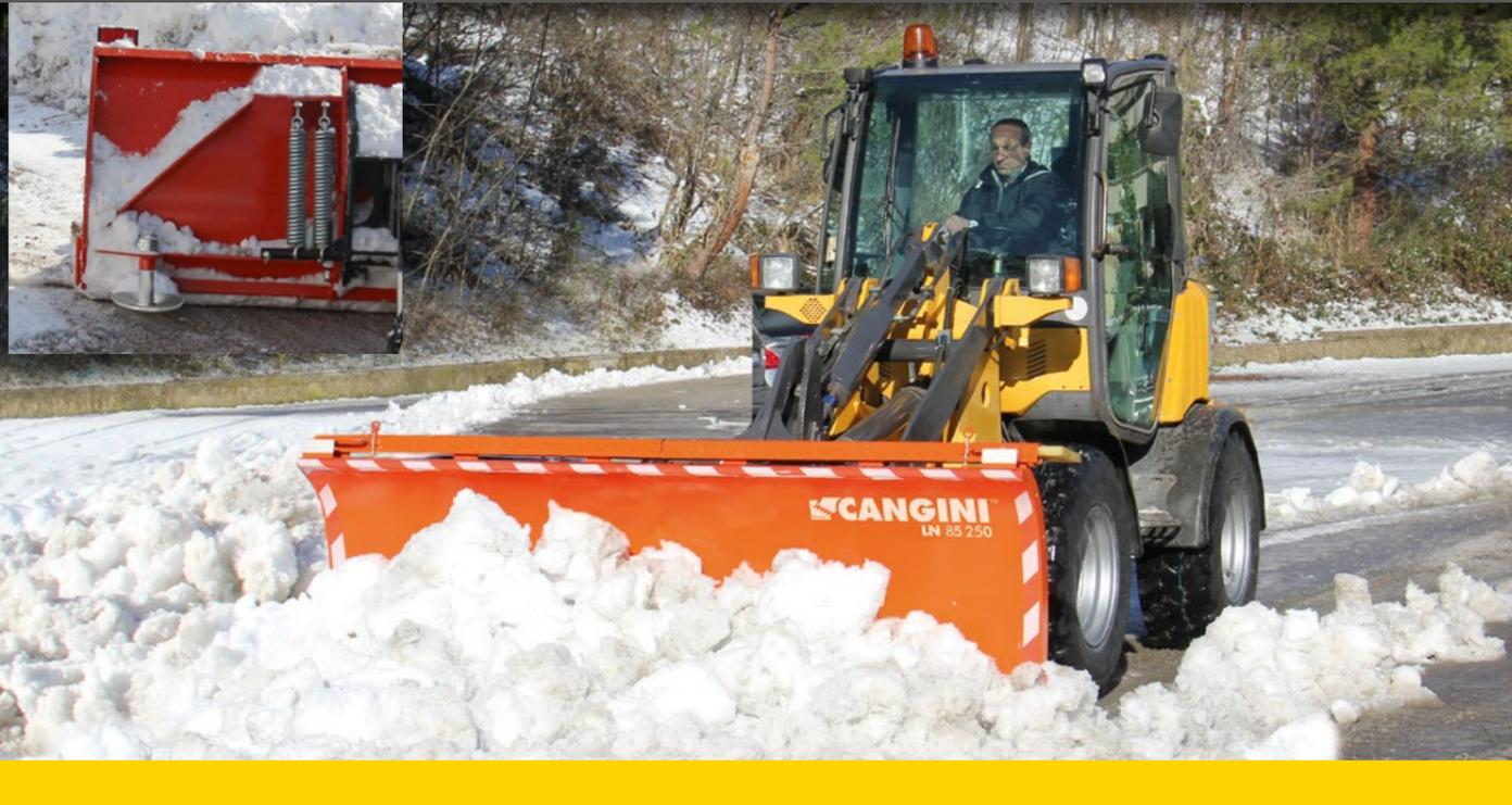
DOTÉE DE VANNES ANTICHOC. RÉGLAGE HYDRAULIQUE DE L'ANGLE DE  $\pm 30^\circ$  ET AUTO-NIVELLEMENT À LA SURFACE DE LA ROUTE DE  $\pm 10^\circ$ . PATINS RÉGLABLES. EN CAS DE COLLISION AVEC UN OBSTACLE, C'EST LE VERSOIR ENTIER QUI SE RENVERSE. RETOUR DU VERSOIR À RESSORTS.
