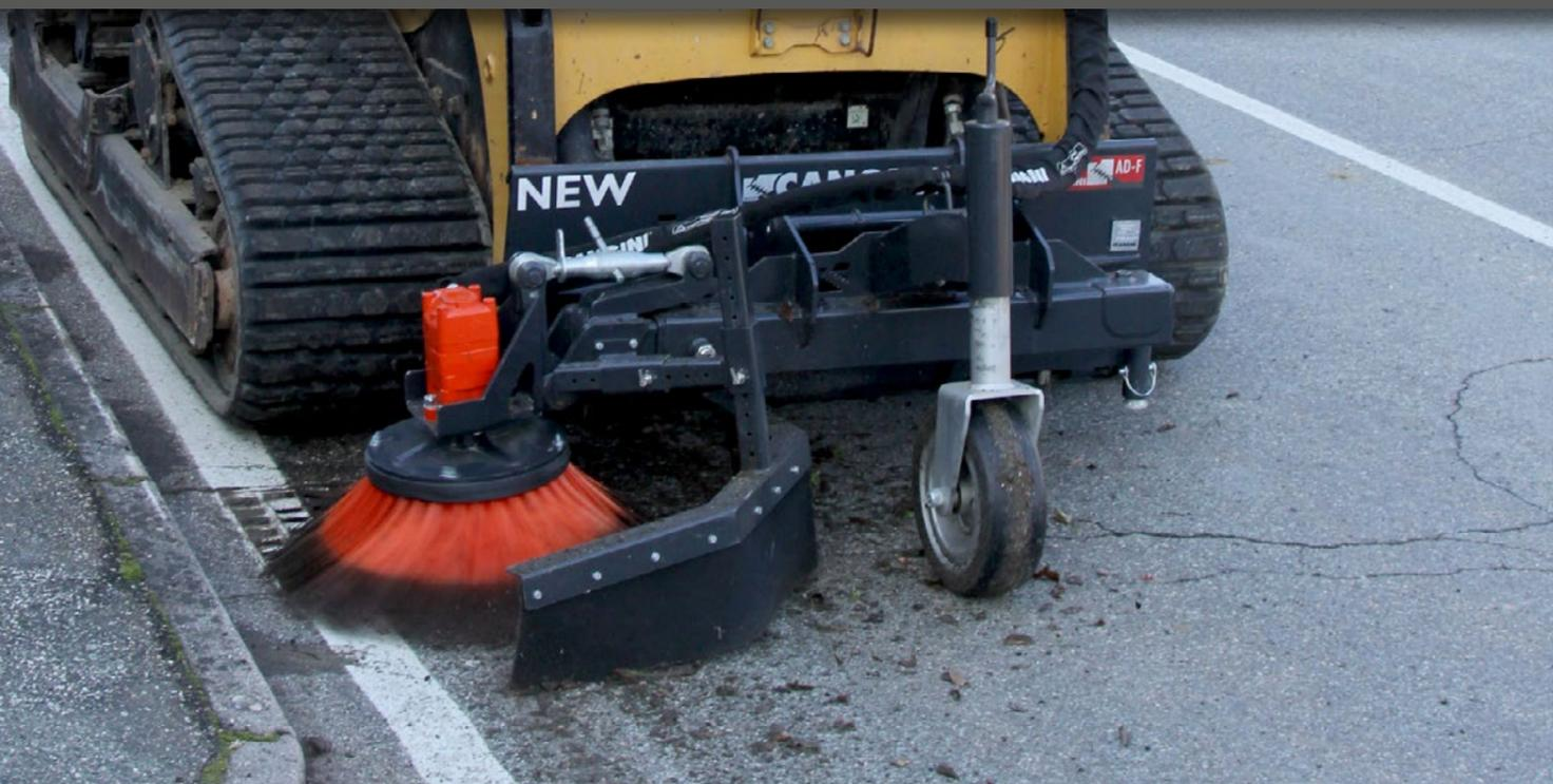
LA BROSSE FRONTALE PEUT ÊTRE FACILEMENT MONTÉE À DROITE ET À GAUCHE, CE QUI VOUS PERMET DE NETTOYER LES DEUX CÔTÉS DE LA ROUTE. LE JOINT ET LE FLOTTEUR LUI PERMETTENT DE SUIVRE LE COURS DU TERRAIN.
