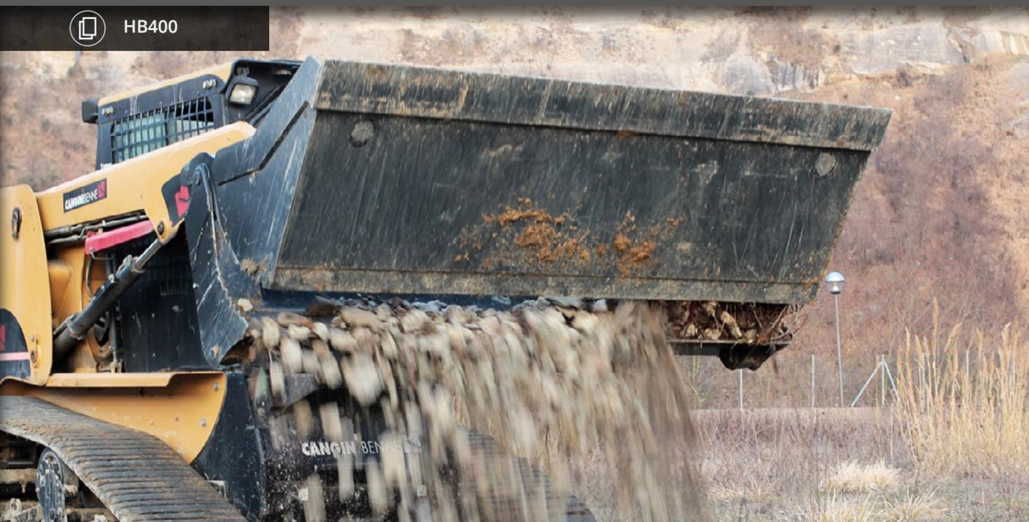
CE GODET EST APPROPRIÉ POUR LES TRAVAUX DE CHARGEMENT, DÉCHARGEMENT ET MANIPULATION. L'OUVERTURE HYDRAULIQUE LUI PERMET AUSSI DE PRENDRE DES OBJETS, DE DOSER LE DÉCHARGEMENT DE MATÉRIEAUX ET DE NIVELER LE SOL.
