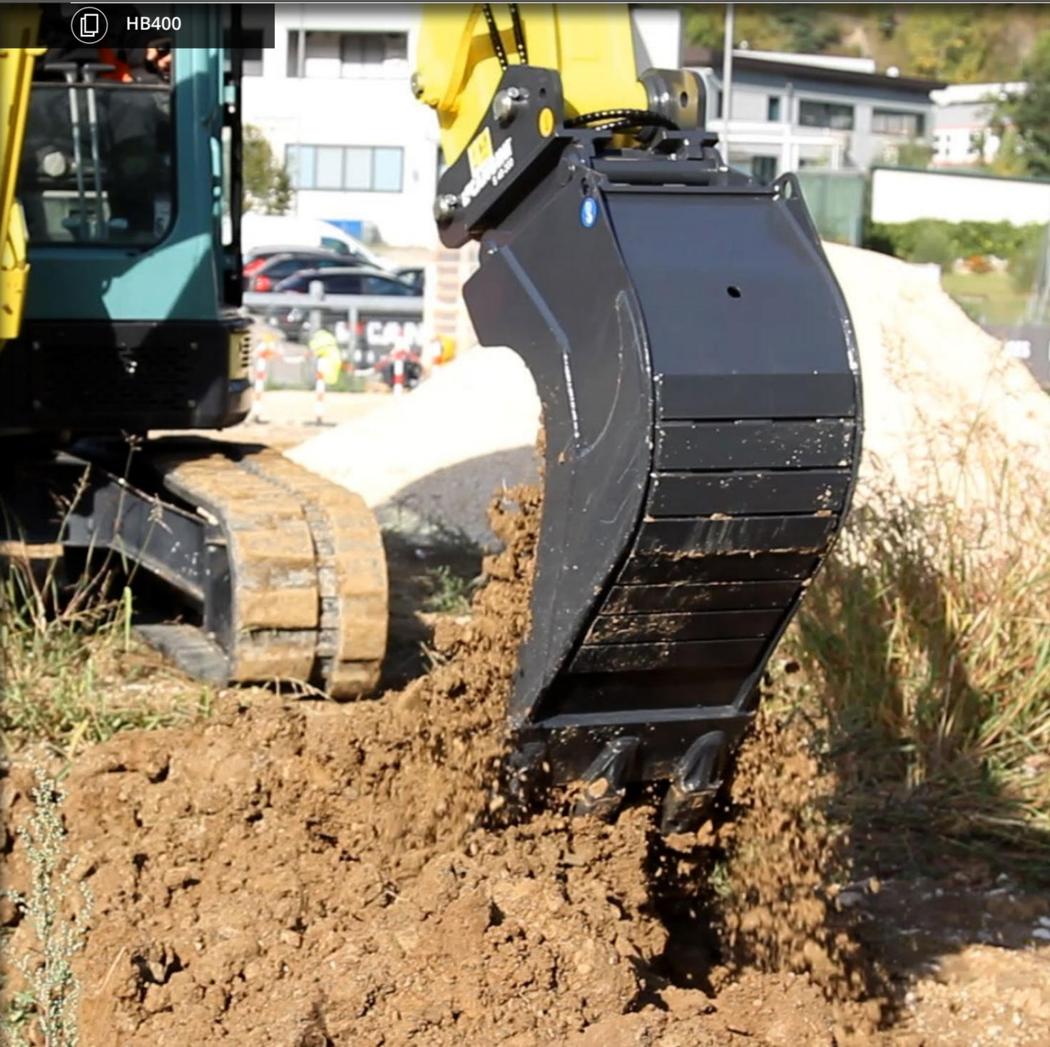
SU FORMA ALARGADA EVITA QUE LA TIERRA SE ADHIERA A LOS COSTADOS, FACILITANDO LA DESCARGA DE MATERIALES ARCILLOSOS Y HÚMEDOS. EL PERFIL CÓNCAVO DE SUS COSTADOS FACILITA LAS OPERACIONES DE ATRAVESAMIENTO DE TUBERÍAS HIDRÁULICAS, DE GAS, ETC. REFUERZO EN TODAS LAS PARTES SUJETAS A MAYOR DESGASTE: LA CUCHILLA, LOS FILOS Y REFUERZOS LATERALES Y LAS BANDAS POSTERIORES SON DE HB400.
