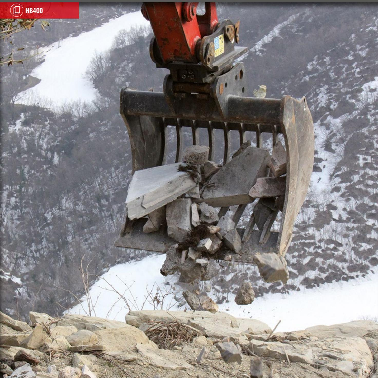
SU FORMA ALARGADA HACE QUE LA TIERRA NO SE ADHIERA A LOS COSTADOS, FACILITANDO LA DESCARGA DE MATERIALES ARCILLOSOS. SU FONDO DE REJILLA ES ESPECIAL PARA EXCAVACIONES EN TERRENOS MUY HÚMEDOS Y PERMITE SELECCIONAR, SEPARAR Y RECICLAR ÁRIDOS. EL CAZO NETHERLANDS TIENE UNA HOJA DE HB400.
