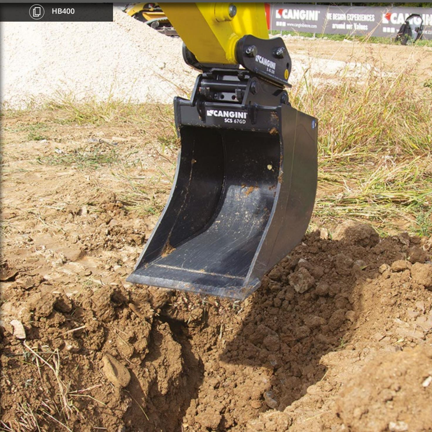
SU FORMA ALARGADA EVITA QUE LA TIERRA SE ADHIERA A LOS COSTADOS, FACILITANDO LA DESCARGA DE MATERIALES ARCILLOSOS Y HÚMEDOS. LA HOJA ESTÁ EN HB400 PARA UNA MAYOR RESISTENCIA AL DESGASTE.
