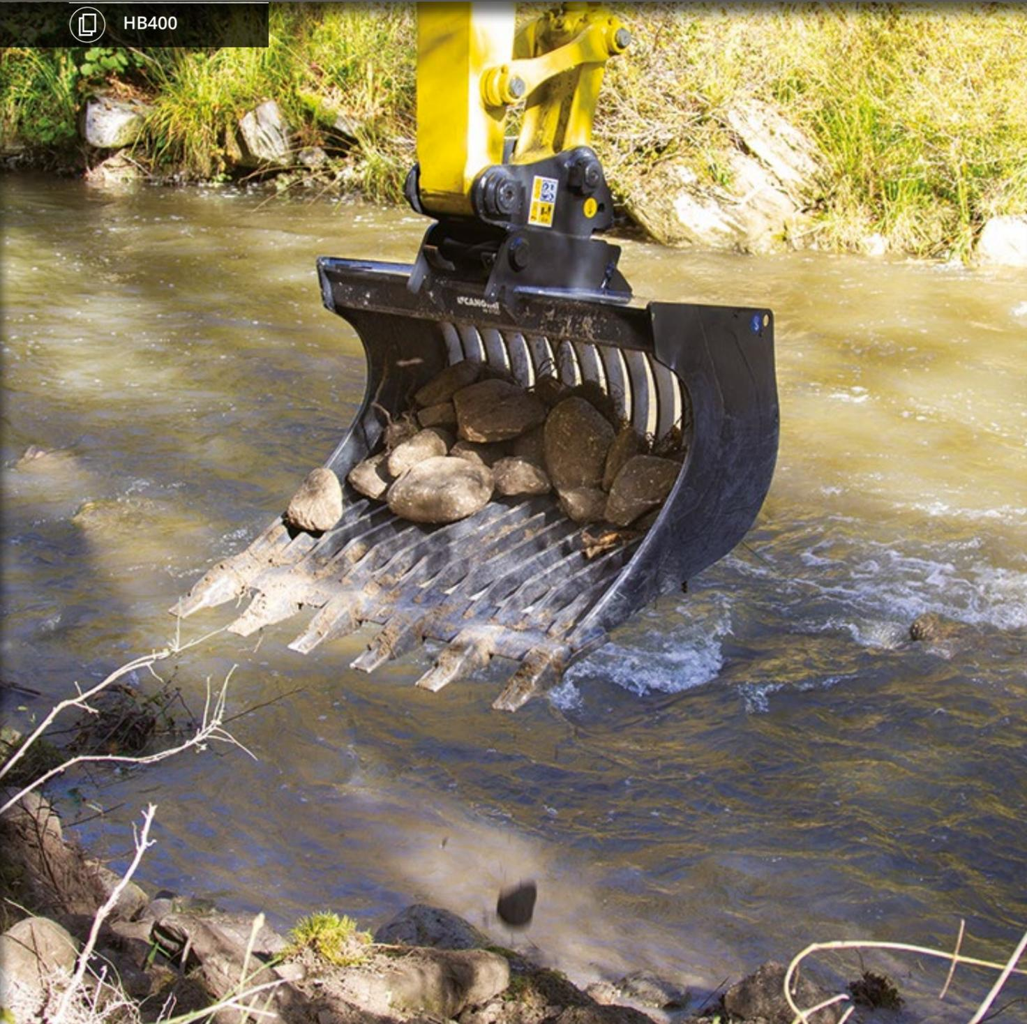
SU FORMA ALARGADA EVITA QUE LA TIERRA SE ADHIERA A LOS COSTADOS, FACILITANDO LA DESCARGA DE MATERIALES ARCILLOSOS Y HÚMEDOS. EL PERFIL CÓNCAVO DE SUS COSTADOS FACILITA LAS OPERACIONES DE ATRAVESAMIENTO DE TUBERÍAS HIDRÁULICAS, DE GAS, ETC. LA HOJA ESTÁ EN HB400 PARA UNA MAYOR RESISTENCIA AL DESGASTE.
