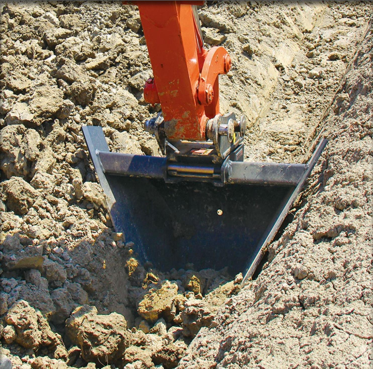
SU FORMA TRAPEZOIDAL Y LA POSIBILIDAD DE INCLINACIÓN DE SUS COSTADOS (52°-60°) PERMITEN LA REALIZACIÓN Y EL MANTENIMIENTO DE ZANJAS Y CANALES DE VARIOS TAMAÑOS E INCLINACIONES.
