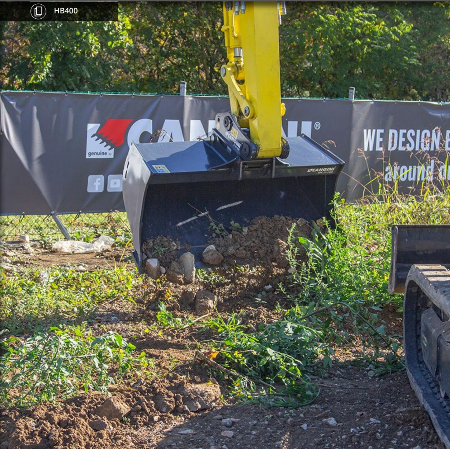
SU FORMA ABOCINADA LA HACE IDEAL PARA EL USO COMBINADO CON EL SISTEMA ROTOTWIST. LA PARTE POSTERIOR, CÓNICA A 8°, PERMITE GIRAR LA CUCHARA DENTRO DE LA EXCAVACIÓN SIN ARRUIÑARLA. LA HOJA ESTÁ EN HB400 PARA UNA MAYOR RESISTENCIA AL DESGASTE.
