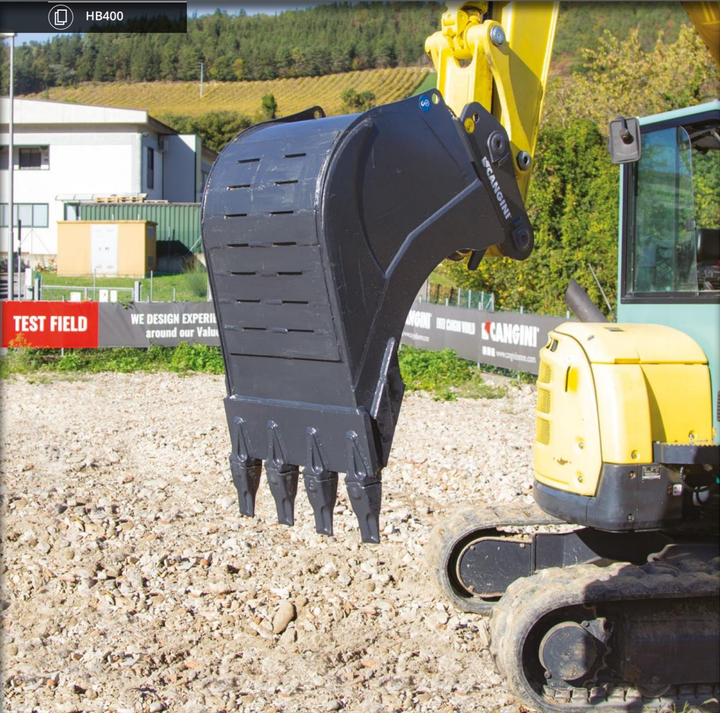
SU FORMA ALARGADA EVITA QUE LA TIERRA SE ADHIERA A LOS COSTADOS, FACILITANDO LA DESCARGA DE MATERIALES ARCILLOSOS Y HÚMEDOS. LA CUCHILLA, LOS FILOS Y REFUERZOS LATERALES Y LAS BANDAS POSTERIORES SON DE HB400.
