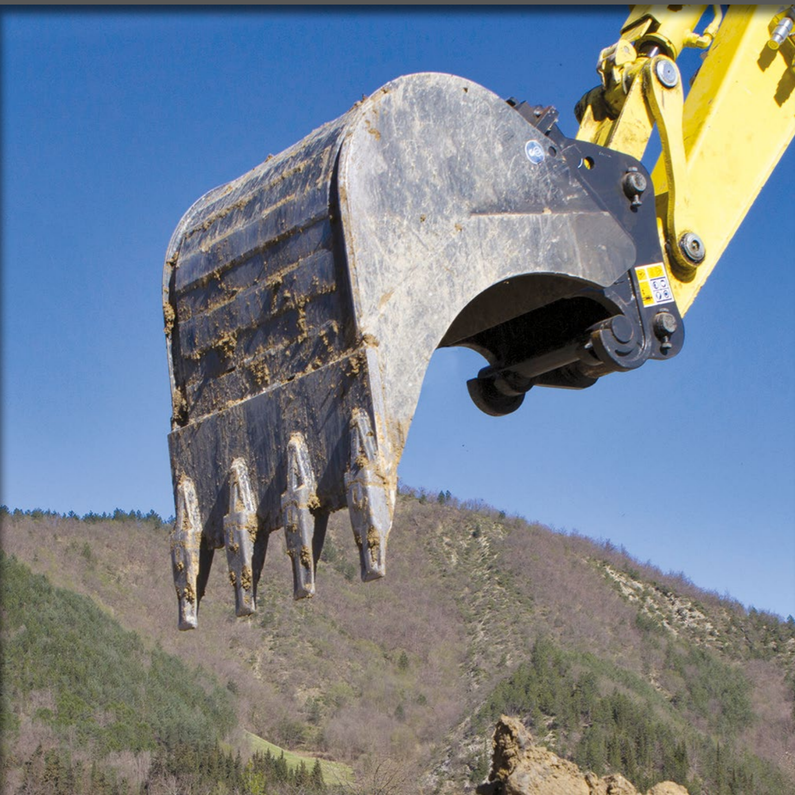
SA FORME EST CONÇUE POUR OPTIMISER LA CAPACITÉ DE PÉNÉTRATION DES TERRAINS MOYENS.
